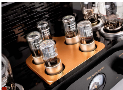
Sekcję preampu i wzmocnienia wstępnego ładnie wyeksponowano. Zastosowano podwójne triody 6SL7 i 6SN7.
