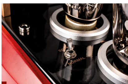
Zmiana punktu pracy lamp końcowych istotnie wpływa na brzmienie. Nazwy dobrze oddają charakter zmian.
